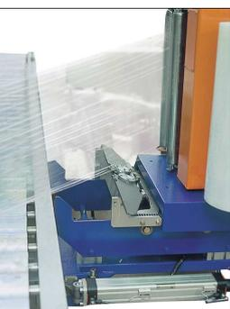
Dispositivi di tenuta e taglio film, riscontro gommato e saldatore a tamponi caldi
